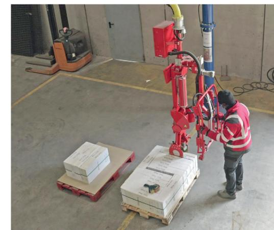
◀ Robot para la manipulación de cerámica. Se trata de una máquina de elevación y accionamiento neumático que facilita la elevación y el descenso de la carga con posibilidad de traslaciones tanto horizontal como vertical.
