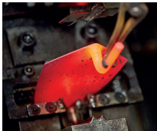
▲ Parte do processo de fabrico da colher de pedreiro. Fabricada em linha contínua e forjada numa única peça, a colher de pedreiro é fabricada em aço especial Bellota.
