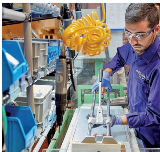
▲ Parte do processo de fabrico da colher de pedreiro. Fabricada em linha contínua e forjada numa única peça, a colher de pedreiro é fabricada em aço especial Bellota.
