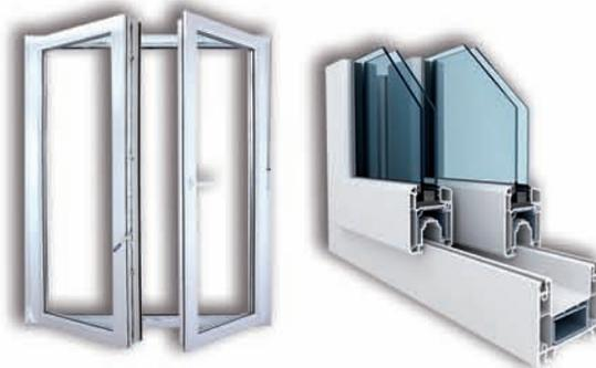
Série S70, perfil 70 com 6 câmaras e vidro que poupa energia 4-16ar-4i glas com factor de transmissão térmica  $U_g = 1.1$ .
