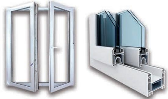
Serie S70, perfil de 70 con 6 cámaras y vidrio de ahorro de energía 4-16ar-4i glas con una transmitancia térmica  $U_g=1.1$ .
